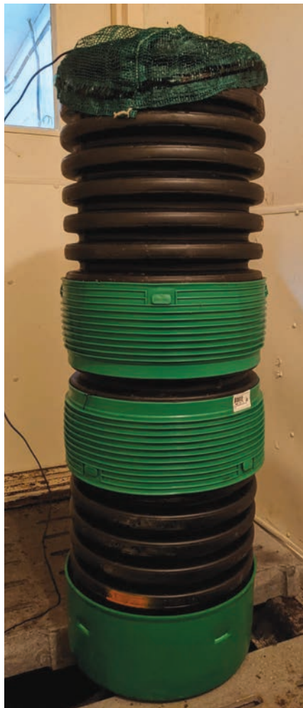
FIGURE 2: PHOTO D'UN DES TUBES UTILISÉS EN LABORATOIRE POUR SIMULER LA COLONNE CENTRALE D'UNE SOP
