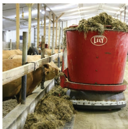
Ce robot d'alimentation fonctionne pratiquement 24 heures sur 24. Il se remplit par lui-même et distribue les rations à l'intérieur de l'étable.
