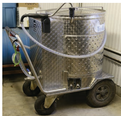
Le taxi-lait peut non seulement transporter le lait d'un endroit à l'autre, mais il permet aussi de le chauffer, le pasteuriser et le refroidir.
