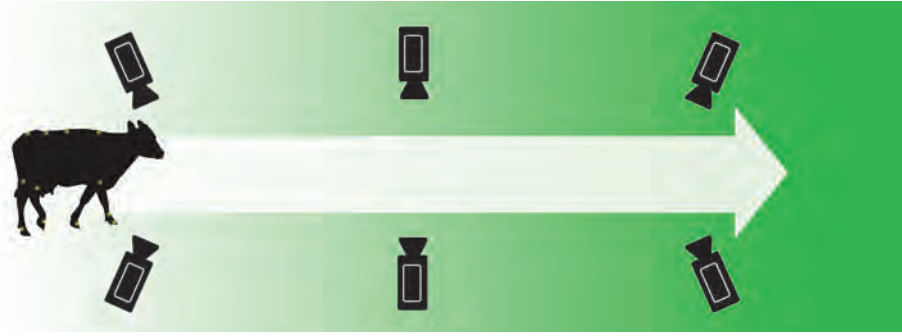
FIGURE 1 : INSTALLATION EXPÉRIMENTALE MONTRANT LES MARQUEURS RÉFLÉCHISSANTS SUR LA VACHE ET LE POSITIONNEMENT DES CAMÉRAS DE CHAQUE CÔTÉ DE L'ALLÉE
